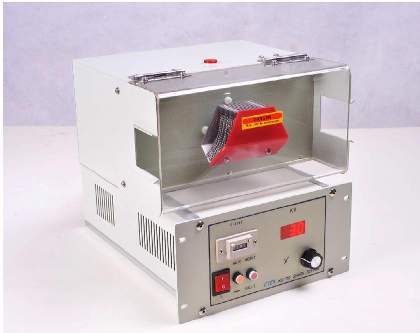
高频火花试验机是一种快速而可靠的检测工具，用以检测各类电线电缆导体之针孔及破皮的高精密度仪器。它可以快速的检测出导体缺陷而不会破坏电导体。使用高频(3KHz)高压电极头取代传统(50/60Hz)电源频率高压电极头，可使其电极头尺寸缩小约 50 倍，而且检测时具有更高的灵敏度。此高频火花试验机是信赖度很高的品管利器。
